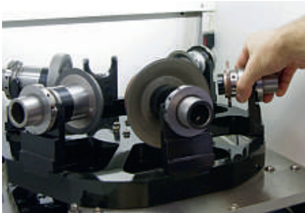
Das Tellermagazin, auf dessen sechs Plätzen der Bediener hauptzeitparallel Schleifscheiben wechseln kann, sorgt für die notwendige Flexibilität.
